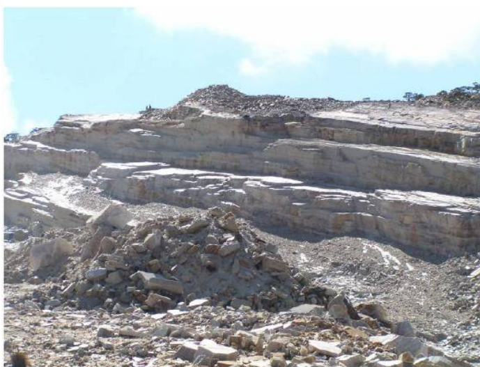
Figura 1 - Frente de lavra e remoção das placas de quartzito foliado – Alpinópolis / MG (Valadão et al, 2010).
